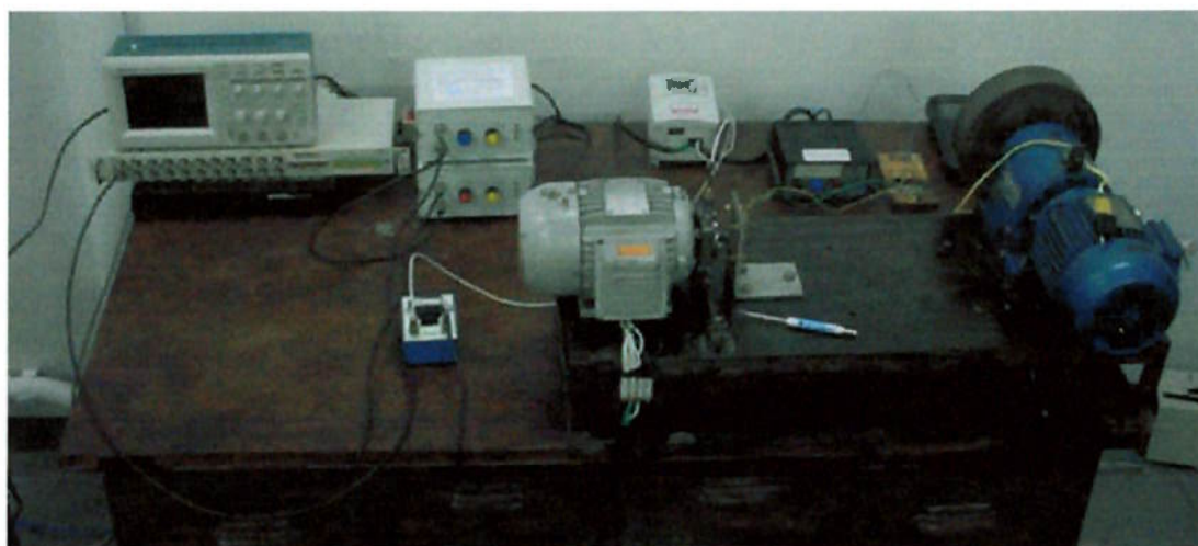
Figura 6.6 – Lay-Out geral da bancada de teste de defeitos de rolamento
