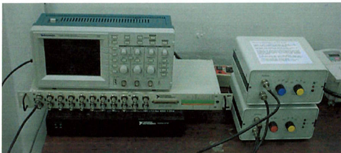
Figura 6.8 – Equipamento de filtro, amplificação e conversão A/D
