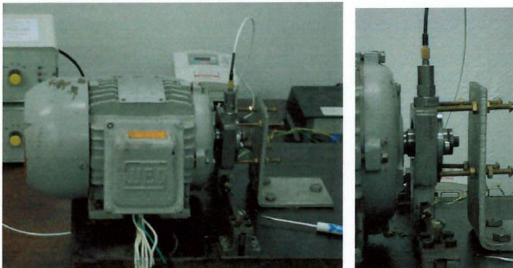
Figura 6.7 – Detalhe da Bancada de Teste (a) motor utilizado para o teste, e (b) detalhe do mancal de rolamento mostrando o posicionamento do acelerômetro acima e a aplicação da carga através do parafuso (embaixo).
